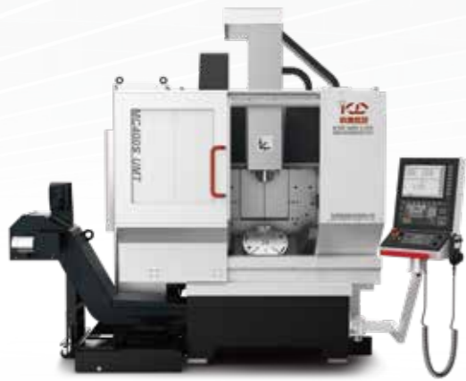
■ KMC400S : 长4591mm × 宽4805mm × 高2610mm
